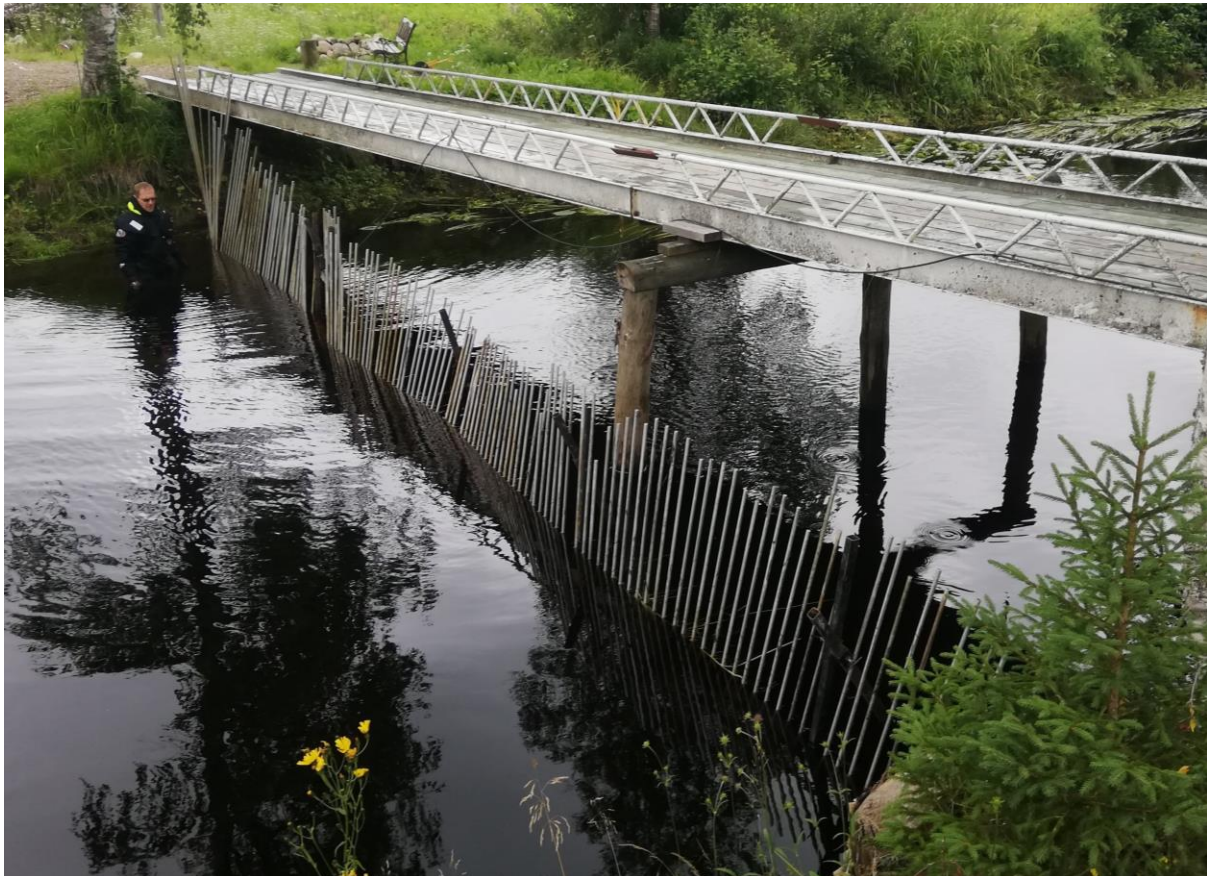
Kuva 13. VAKI-kalalaskuri sekä ohjainaidat asennettuna jokeen Villamon yläpuolella vuonna 2020.
