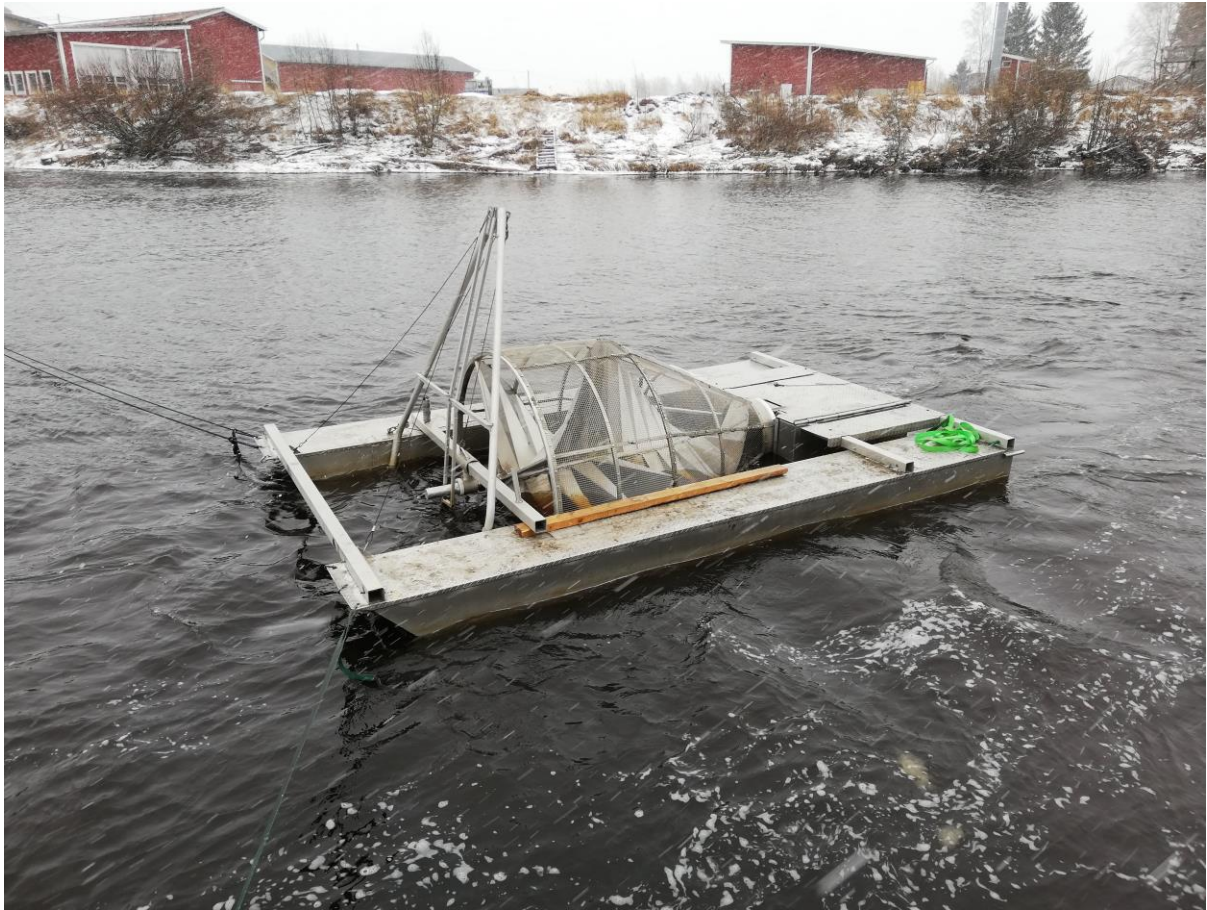
Kuva 7. Smolttiruuvi pyyntiin asennettuna Sandrgundforsin alapuolella.
